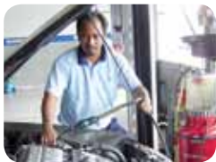
Alat pam minyak enjin pneumatik dan pengumpul sisa : menyedut
