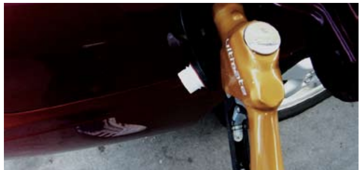
ISI... Tangki minyak yang kerap kosong mengundang pencemaran dan kelembapan ke dalam sistem bahan api.
