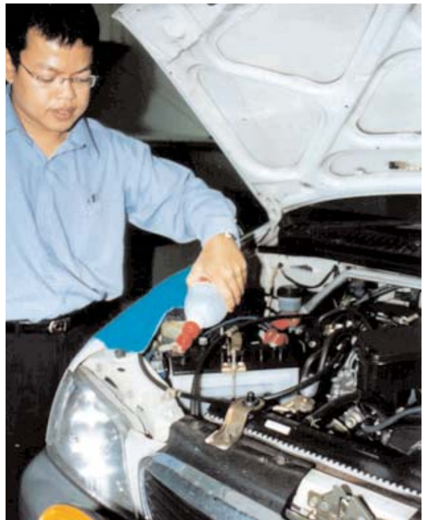
TAMBAH... Paras air bateri perlu sentiasa berada pada tahap minimum dan maksimum yang tertera pada sisi bateri.
